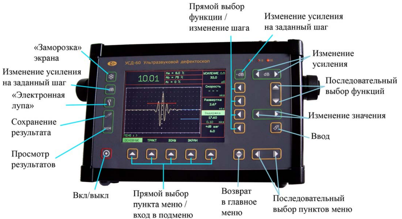
Рис 1-2—Клавиатура дефектоскопа
